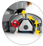
Sistema secador con doble aspiración alternada (patentado)
