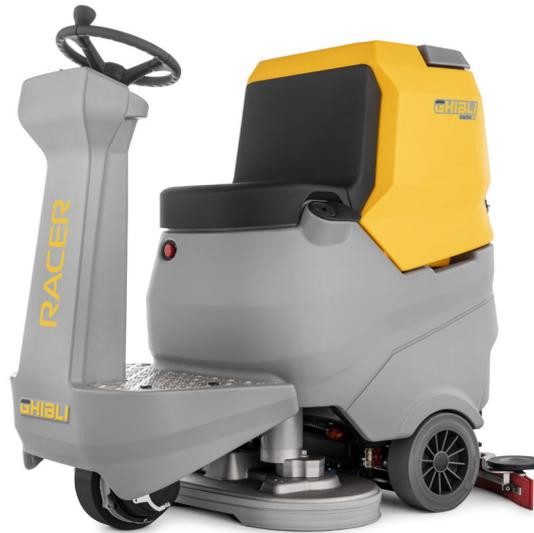
die auch Bedienern mit weniger Erfahrung die Verwendung dieser professionellen Scheuersaugmaschine ermöglichen. Racer ist in vier Ausführungen erhältlich, einer Grundausführung und drei Full Packages (BC, BC PLUS und BC Lithium), inklusive Akkus und Ladegerät. In der BC PLUS-Ausführung erreicht Racer eine Autonomie von 4 Stunden und in der Version BC Lithium von zwei Stunden
