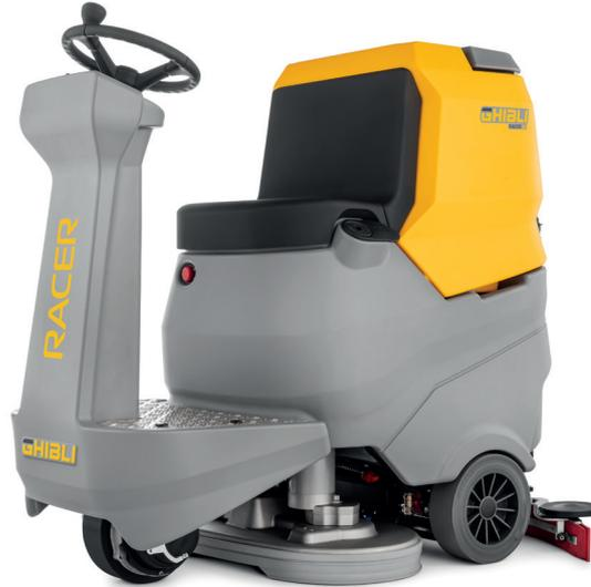
weniger Erfahrung die Verwendung dieser professionellen Scheuersaugmaschine ermöglichen. Racer ist in vier Ausführungen erhältlich, einer Grundausführung und drei Full Packages (BC, BC PLUS und BC Lithium), inklusive Akkus und Ladegerät. In der BC PLUS-Ausführung erreicht Racer eine Autonomie von 4 Stunden und in der Version BC Lithium von zwei Stunden!
