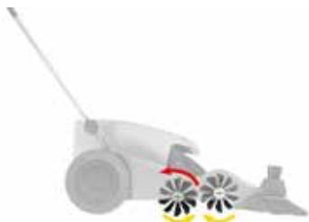
L'innovativo sistema DUAL SWEEPING MODE (DSM) garantisce il riempimento completo del contenitore. Grazie al movimento combinato delle spazzole centrali che ruotano in senso opposto il materiale raccolto viene ribaltato e convogliato all'interno del contenitore in modo più efficace rispetto ai normali meccanismi spazzanti.
