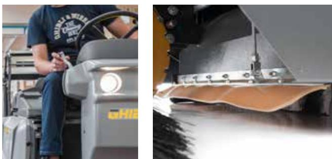
HS R 130 è in grado di affrontare qualsiasi tipo di sporco grazie alla possibilità di regolare la pressione della spazzola centrale e di abbassare o sollevare le spazzole laterali, a seconda della necessità, attraverso un pratico sistema di leve. Il sollevamento a pedale del flap centrale consente di raccogliere anche materiali e oggetti di piccole dimensioni.
