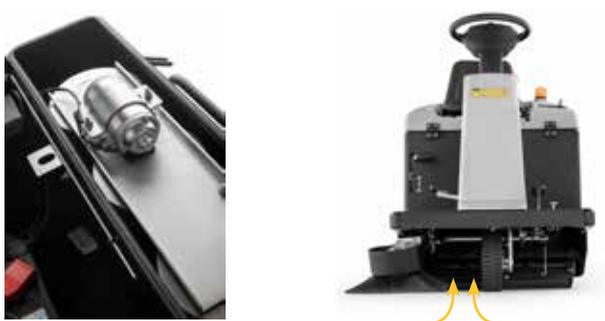
I tre filtri a cartuccia, semplici da pulire grazie allo scuotifiltro elettrico, e l'aspirazione sulla spazzola laterale destra per eliminare la polvere sollevata durante il lavoro, permettono all'operatore di pulire con HS R 110 in tutta sicurezza.
