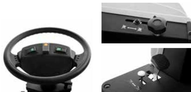
La pratica manopola, posizionata su piantone dello sterzo, permette di regolare l'altezza della spazzola laterale, garantendo così una pulizia perfetta. Inoltre, il comodo pedale alzaflap consente alla macchina di raccogliere senza difficoltà anche i rifiuti più ingombranti.
