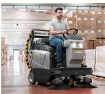
La HS R 130 es una barredora robusta y segura: su estructura de acero está específicamente diseñada para soportar golpes, está equipada con un sistema antiestático certificado y presenta una excelente distribución del peso para los cambios bruscos de dirección. Una baliza intermitente y un sistema de iluminación frontal, ambos de serie, completan la máquina.
