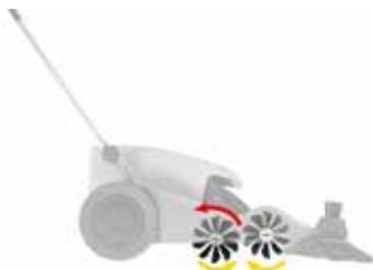
El innovador sistema DUAL SWEEPING MODE (DSM) asegura el llenado completo del contenedor. Gracias al movimiento combinado de los cepillos centrales que giran en sentido opuesto, el material recogido es volcado y transportado hacia el interior del contenedor de manera más eficaz que con los mecanismos de barrido normales.
