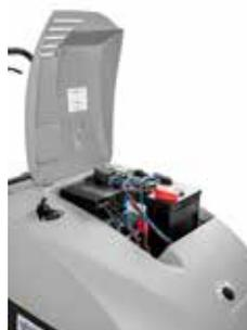
Gracias a la práctica puerta situada en la parte superior de la HS MT 80, los principales componentes de la máquina son de fácil y rápido acceso, incluso para los operadores menos experimentados.
