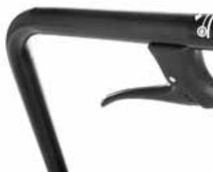
La HS MT 80 cuenta con tracción mecánica de velocidad variable y puede accionarse directamente con la palanca situada en el manubrio reclinable, esto permite trabajar con total comodidad y sin realizar esfuerzos.
