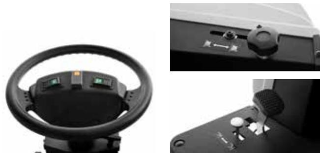
El práctico pomo, situado en la columna de dirección, permite regular la altura del cepillo lateral, garantizando así una limpieza perfecta. Además, el cómodo pedal levantador de aletas permite que la máquina recoja incluso los residuos más voluminosos sin dificultad.
