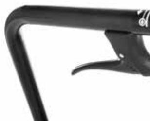
HS MT 80 est dotée de traction mécanique, à vitesse variable et directement actionnable depuis le levier situé sur le guidon inclinable, qui permet de travailler sans fatigue et en totale commodité.
