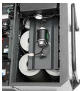
Les 6 filtres à cartouche en papier, faciles à nettoyer grâce au secoue-filtre électrique, garantissent une surface filtrante élevée et empêchent la dispersion des poussières dans le milieu ambiant, ce qui permet à l'opérateur de travailler dans un environnement sain.
