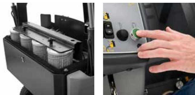
La machine est équipée d'un puissant système filtrant, composé de 8 filtres à cartouche en polyester et d'un secoue-filtre électrique, qui retient les poussières déplacées pendant la phase de travail pour permettre à l'opérateur de travailler en toute sécurité.
