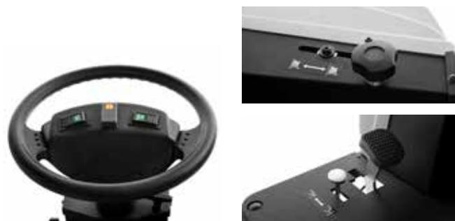
Практичная рукоятка, расположенная на рулевой колонке, позволяет регулировать высоту боковой щетки, обеспечивая идеальную уборку. Кроме того, удобная педаль подъема позволяет машине без труда поднимать даже самые крупногабаритные отходы.
