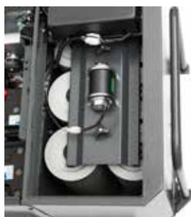
6 картриджных бумажных фильтров, которые легко очищаются благодаря электрическому встряхивателю фильтров, обеспечивают высокую площадь фильтрующей поверхности и предотвращают рассеивание пыли в окружающее пространство, гарантируя оператору работу в здоровой среде.
