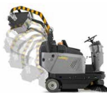
Модели HS R 130 ADM оснащены практической системой автоматического сброса (ADM), управляемой с панели управления, которая позволяет поднимать отсек для сбора отходов на высоту до 145 см и быстро и легко выгружать содержимое прямо в мусорный бак.
