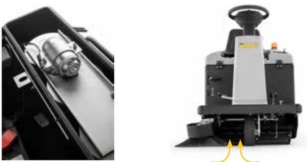
Три картриджных фильтра, которые легко чистить благодаря электрическому встряхивающему механизму, и всасывание на правой боковой щётке для удаления пыли, поднимаемой во время работы, позволяют оператору осуществлять уборку с помощью HS R 110 в условиях полной безопасности.
