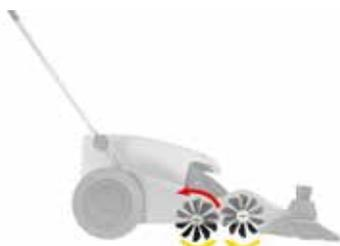
Инновационная система DUAL SWEEPING MODE (DSM) обеспечивает полное заполнение контейнера. Благодаря комбинированному движению центральных щеток, которые вращаются в противоположном направлении, собранный материал переворачивается и перемещается внутрь контейнера более эффективно, чем в традиционных подметальных механизмах.
