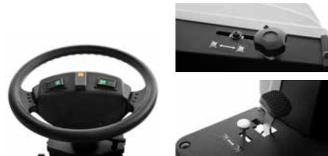
Mit dem praktischen Drehknopf an der Lenksäule lässt sich die Höhe der Seitenbürste verstellen, so dass eine perfekte Reinigung gewährleistet ist. Außerdem kann die Maschine dank des praktischen Hubpedals selbst sperrige Abfälle problemlos aufnehmen.
