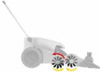
Das innovative System DUAL SWEEPING MODE (DSM) gewährleistet, dass der Behälter ganz gefüllt wird. Dank der kombinierten Bewegung der mittleren Bürsten, die gegeneinander drehen, wird das aufgefegte Material umgedreht und viel besser in den Behälter befördert als bei den herkömmlichen Kehrmechanismen.
