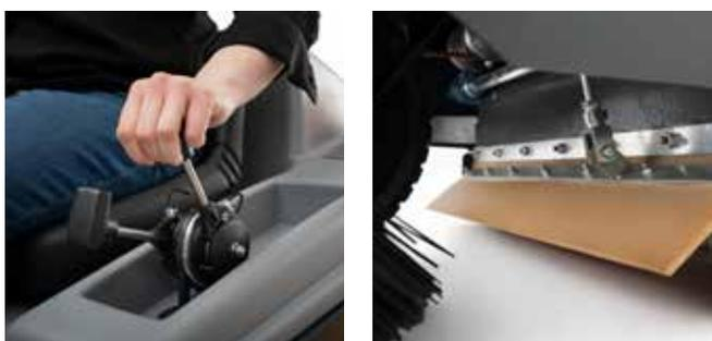
HS R 120 ist mit praktischen Hebeln zum Anheben der Seitenbesen ausgestattet, die je nach Verschmutzungsgrad eingesetzt werden können, und der Bediener kann den Druck der mittleren Bürste über einen praktischen Hebel einstellen. Darüber hinaus ermöglicht das Anheben der mittleren Klappe per Pedal die Aufnahme von Materialien und kleinen Gegenständen.
