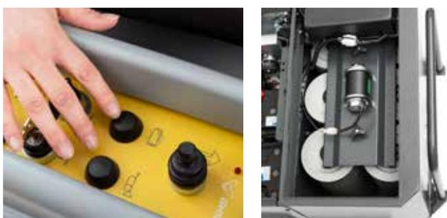
Die 6 Patronenfilter sind aufgrund des elektrischen Filtrerrüttlers leicht zu reinigen und gewährleisten eine große Filterfläche. Sie verhindern die Ausbreitung von Staub in das Ambiente, so dass der Bediener in einem gesunden Ambiente arbeiten kann.
