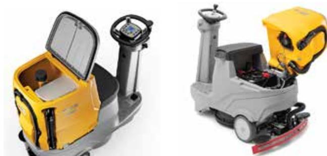
La fase di manutenzione è pratica e semplice anche per gli operatori meno esperti. Il serbatoio di recupero, il filtro di aspirazione e il contenitore che trattiene i detriti aspirati di grandi dimensioni (debris tray), infatti, possono essere raggiunti e puliti con facilità ed immediatezza. Anche il vano batterie e caricabatterie è comodamente accessibile per l'utilizzatore.
