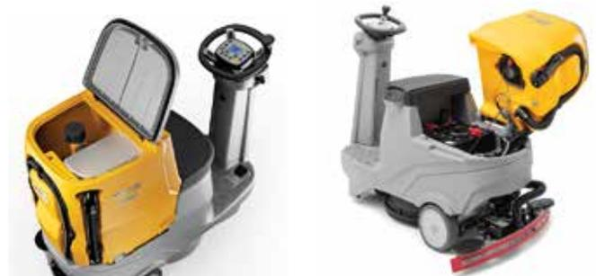
Die Wartungsphase ist praktisch und einfach, auch für weniger erfahrene Bediener. Der Rückgewinnungsbehälter, der Saugfilter und der Behälter für die großen angesaugten Abfälle (Schmutzbehälter) sind **einfach** und schnell zu erreichen und zu reinigen. **Auch das Batterie- und Ladegerätfach** ist für den Benutzer bequem zugänglich.
