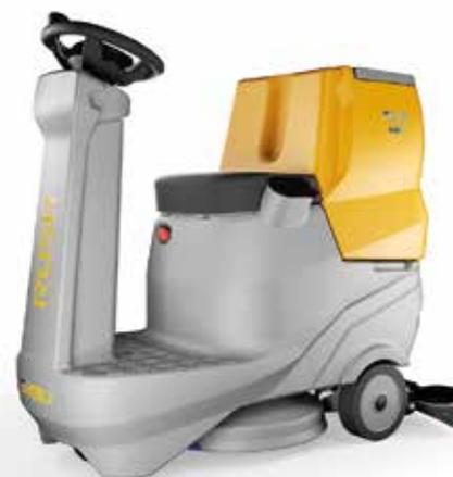
Mit einem Fassungsvermögen von 65 Litern, einer Waschspur von 55 cm und einer Saugbreite von 75 cm kann die Maschine eine Produktivität von 3200 m<sup>2</sup>/h gewährleisten.
