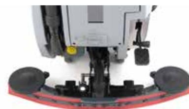
Der **kompakte und widerstandsfähige 750-mm-Wischer** garantiert dank seines leistungsstarken 380-W-Saugmotors und der serienmäßigen Naturkautschuk-Gummis hervorragende Trocknungsergebnisse, die bei der normalen Reinigung und auf Böden mit stärkerer Verschmutzung unübertroffen sind. Einfach einzustellen und zu entfernen (*kein Werkzeug erforderlich*).
