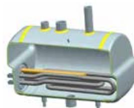
La grande chaudière en acier inoxydable, grâce à sa capacité de 3,5 l et à sa résistance de 3400 W, est en mesure de produire jusqu'à 6 kg H<sub>2</sub>O/h de vapeur.
