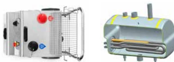
La grande chaudière à recharge continue en acier inoxydable, grâce à sa capacité de 4,2 l et à sa résistance de 9000 W, est en mesure de produire jusqu'à 15 kg H<sub>2</sub>O/h de vapeur. S-Team 10 TP VH permet donc de travailler sans devoir faire de longues pauses pour remplir la chaudière d'eau tout en maintenant ses performances. En outre, il est équipé d'un système de sécurité efficace qui arrête automatiquement la machine en cas d'urgence.
