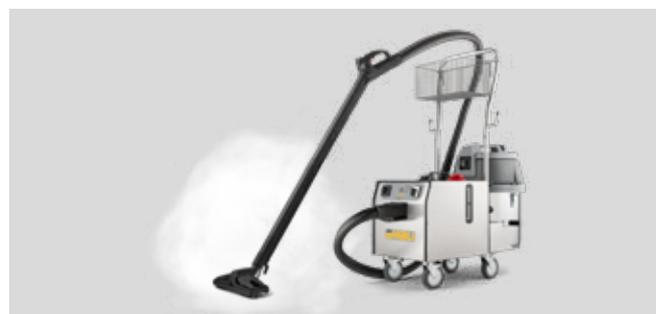
Les modèles S-Team 6 V et S-Team 10 VH sont équipés du puissant moteur d'aspiration de 1150 W, qui peut également être installé sur le S-Team 10 TP VH. La combinaison de la vapeur sèche à haute température, de la pression de fonctionnement de 6 à 10 bar et de la puissance de l'aspirateur intégré dans les machines garantit d'excellents résultats de nettoyage et de séchage des surfaces.
