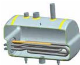
La gran caldera de recarga de acero inoxidable, con una capacidad de 3,5 l y una resistencia de 3400 W, puede producir hasta 6 kg H<sub>2</sub>O/h de vapor.
