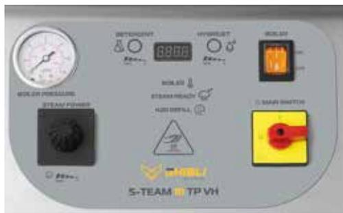
El panel de mando con pantalla permite controlar y gestionar todas las funciones de la máquina de forma rápida y sencilla. En concreto, la función detergente permite combinar la potencia del vapor con la acción química del agua y el detergente para eliminar incluso la suciedad más incrustada, mientras que la función hydrojet permite combinar la potencia del vapor con la acción física del chorro de agua para eliminar incluso la suciedad más incrustada.
