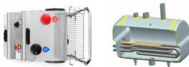
La gran caldera de recarga de acero inoxidable, con una capacidad de 4,2 l y una resistencia de 9000 W, puede producir hasta 15 kg H<sub>2</sub>O/h de vapor. De este modo, S-Team 10 TP VH le permite trabajar sin tener que hacer largas pausas para rellenar agua en la caldera, manteniendo el rendimiento. Además, está equipado con un eficaz sistema de seguridad que apaga automáticamente la máquina en caso de emergencia.
