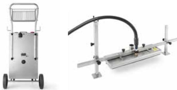
El S-Team 10 TP VH, con su motor trifásico de 9000 W, es una máquina extremadamente potente, capaz de limpiar e higienizar a fondo incluso la suciedad más dura y difícil de eliminar. Este generador de vapor está especialmente indicado para el sector industrial y para algunos tratamientos específicos, como la limpieza e higienización de cintas en líneas de producción y barricas utilizadas en bodegas, gracias a algunos accesorios opcionales específicamente diseñados para estas operaciones.
