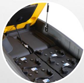
Il sistema dei serbatoi ribaltabili garantisce un accesso veloce e senza problemi al motore di aspirazione e al comparto batterie.
