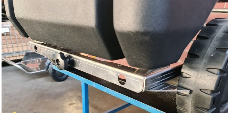
Détail du bouton de frein bloqué sur l'essieu arrière
