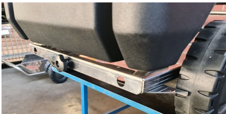
Particolare del pomello del freno in fase di blocco sull'assale posteriore
