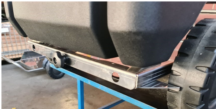
Detailansicht des Bremsknopfs beim Anziehen der Feststellbremse an der Hinterachse
